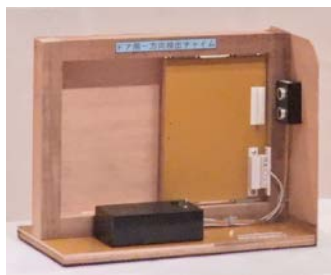
【ドア用一方向検出チャイム】 第69回鹿児島県発明くふう展 鹿児島県教育委員会賞
